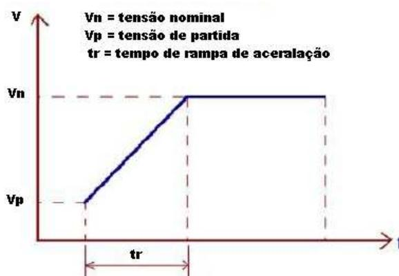
Figura 5. Curva de aceleração de um MIT usando *soft-starter*.
